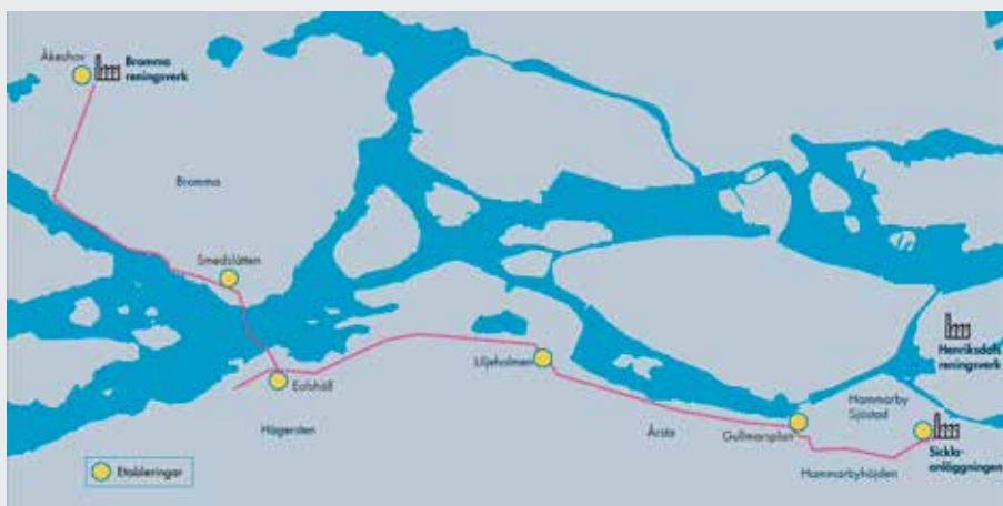
Avloppstunnelns sträckning från Bromma reningsverk till Sicklaanläggningen vid Hammarbybacken. På sex platser, markerade på kartan, har vi våra etableringar där vi kör ut de utsprängda bergmassorna från tunnelbygget.
