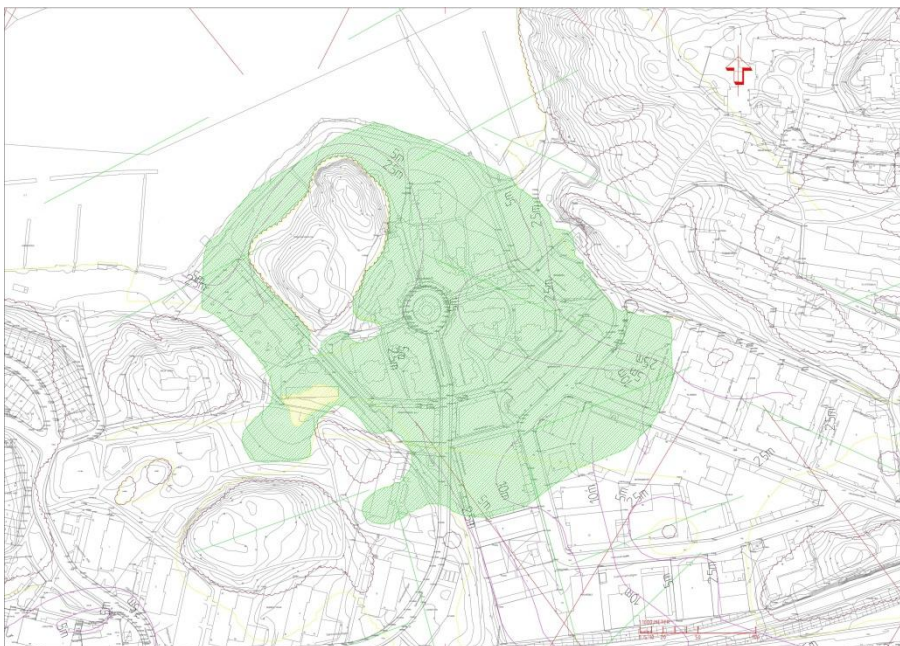
Figur 16. Illustration av beräknade sättningar för område 6 och 7 med injekteringsnivå 1e-9, baserat på antagen variation för grundvattensänkning utmed tunneln och bedömd mäktighet av det lösa lerlagret, samt med förutsättningen att inga andra skyddsåtgärder såsom ersättningsinfiltration etc. görs. Grön färg avser 0 - 3 cm sättning och gul färg 3 - 6 cm sättning på 100 år.
