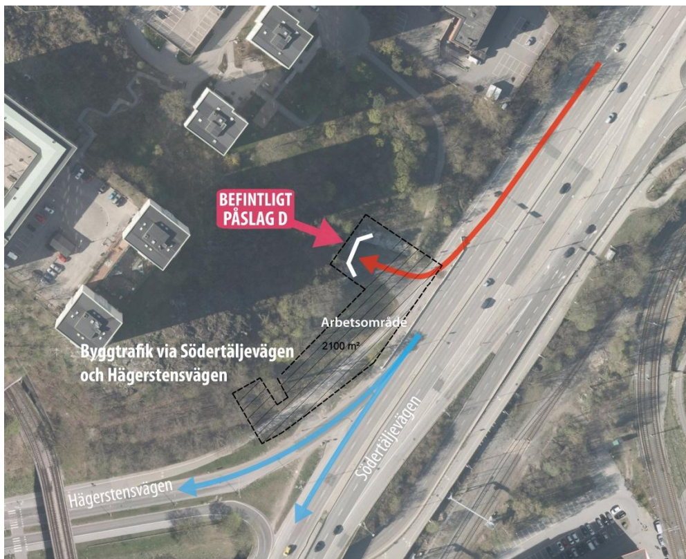
Figur 49. Befintligt tunnelpåslag, planerat arbetsområde och utfart.
