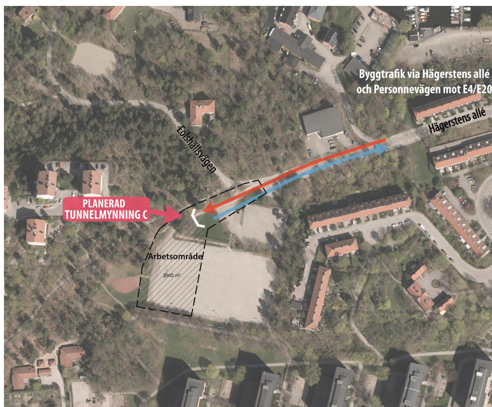
Figur 44. Planerat tunnelpåslag, planerat arbetsområde och utfart
