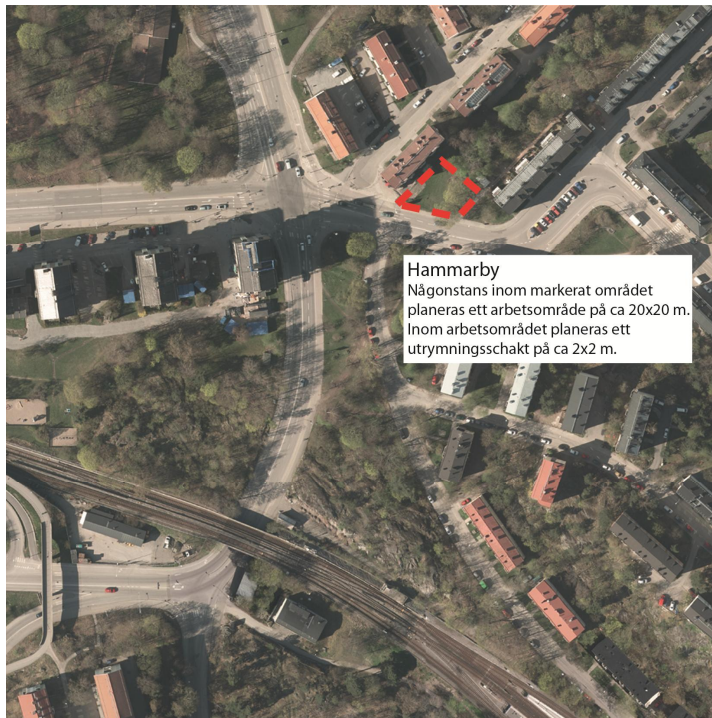
Figur 34 Arbetsområde utrymningsschakt Hammarby
