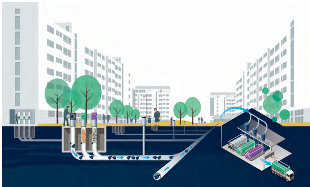
Figur 3. Illustration över ett stationärt sopsugssystem med tre fraktioner.
