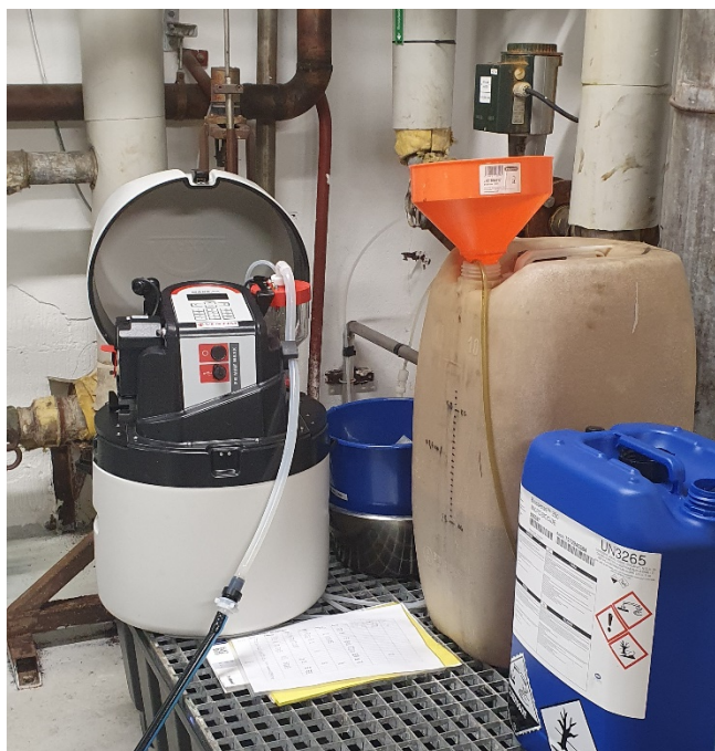
Figur 3.1. På Industri A togs ett prov med dygnsprovtagare (t.v.) och ett stickprov i bassäng (t.h.).
