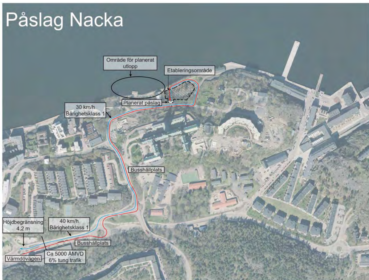
Figur 5. Föreslaget påslagsläge (tunnelmynning) till arbetstunnel vid Finnbo i Nacka inkl. föreslagna transportvägar under byggskedet. Arbetstunnelns sträckning redovisas ej.
