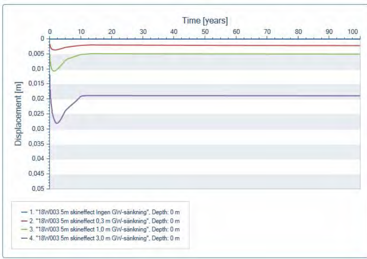
Figur 39. Diagrammet visar marksättningsens tillväxt vid nuvarande spänningssituation samt vid 0,3, 1,0 och 3,0 meters grundvattensänkning i undersökningspunkt 18W003 vid en lermäktighet på 5 meter och med hänsyn till "skineffekt".
