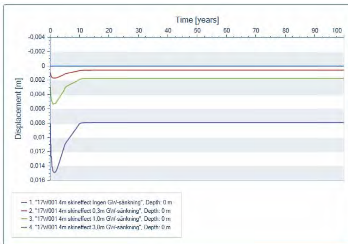
Figur 6. Diagrammet visar marksättningsens tillväxt vid nuvarande spänningssituation samt vid 0,3, 1,0 och 3,0 meters grundvattensänkning i undersökningspunkt 17W001 vid en lermäktighet på 4 meter och hänsyn till "skineffekt".
