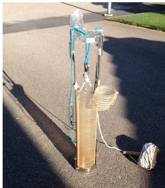
Foto 1. Sedimenthämtare som användes för att skiva sedimenten i önskade centimeternivåer, 0-30 cm (Foto: ALcontrol AB).
