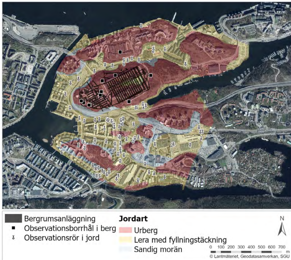
Figur 31. Grundvattenobservationsrör som inventerats eller installerats inom ramen för utredningen.
