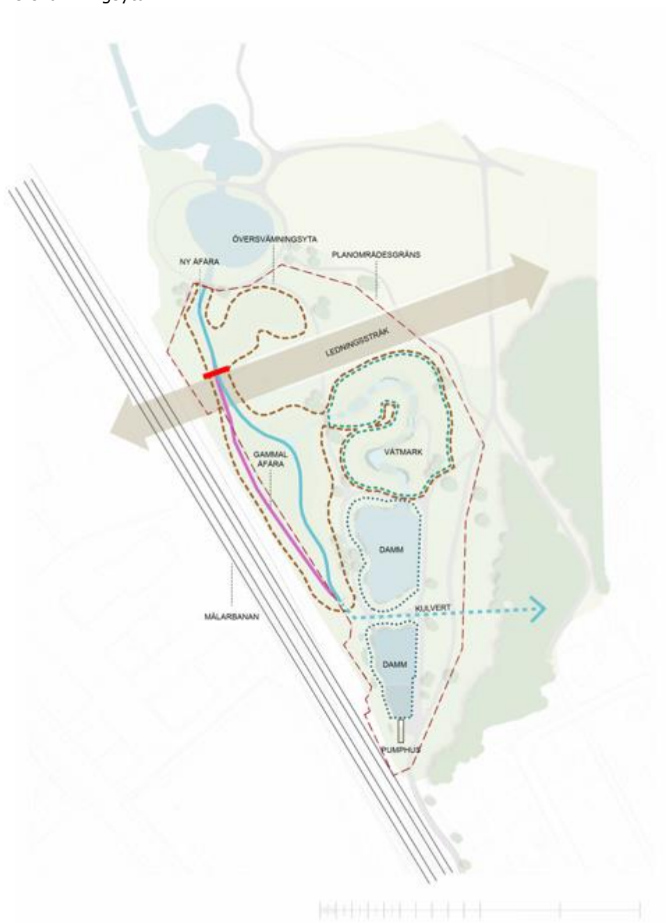
Figur 3. Skiss över möjlig utformning av anläggningsområde för dagvattenpark. Röd linje markerar lokalisering av provisorisk byggväg över Bällstaån.
