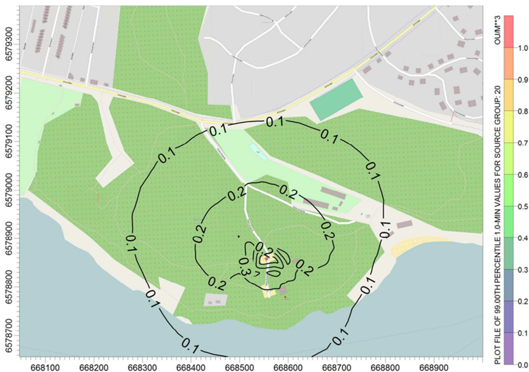
Figur 6-7 Scenario 6 Luktemission 3,6 MI.e./h vid flödet 1 000 m 3 /h och höjden 20m.
