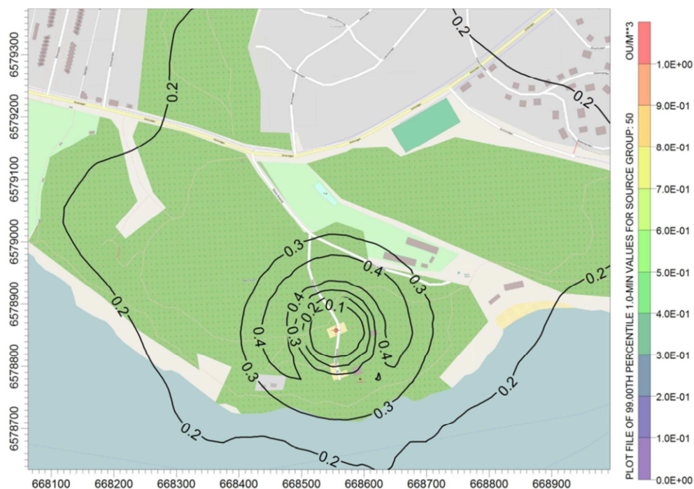
Figur 6-5 Scenario 4. Luktemission 37 Ml.e./h vid flödet 10 000 m 3 /h och höjden 50m.
