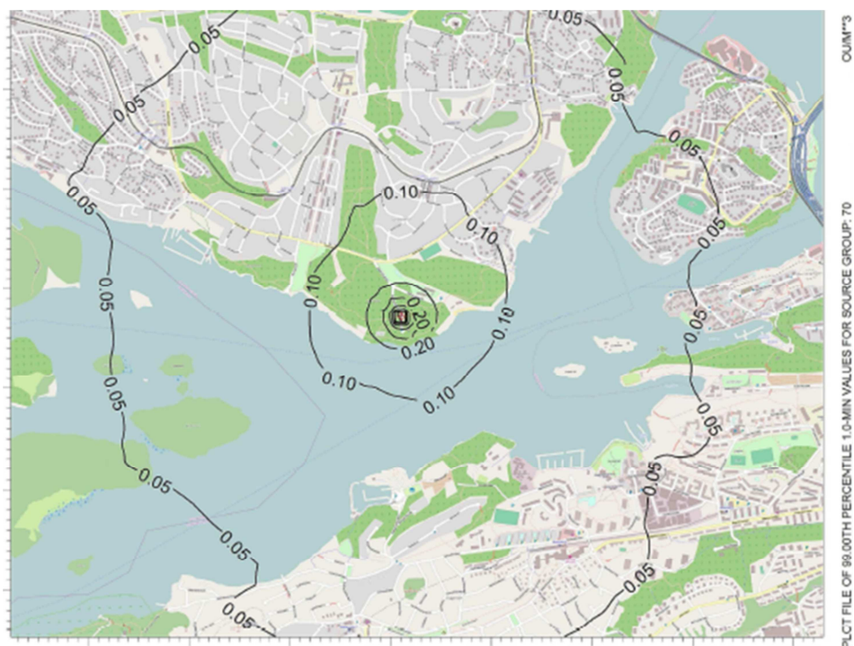
Figur 6-6 Scenario 5 Luktemission 37 Ml.e./h vid flödet 10 000 m 3 /h och höjden 70 m.
