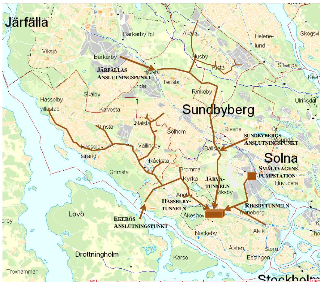
Figur 8. Brommas avloppsledningsnät. Figuren gjord av Mattias Lindgren.
