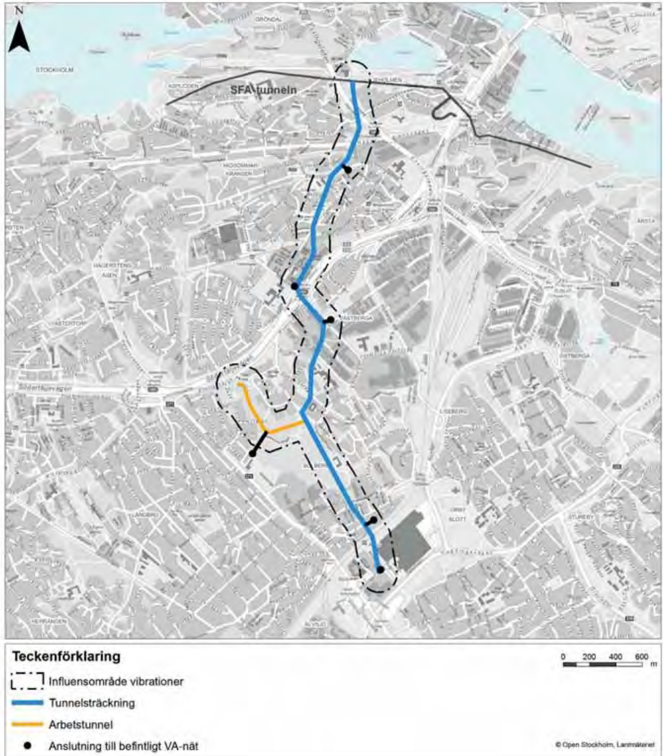
Figur 31 Influensområde för vibrationer. Inom detta område har byggnader och andra anläggningar inventerats för att ansätta restriktioner för vibrationer.
