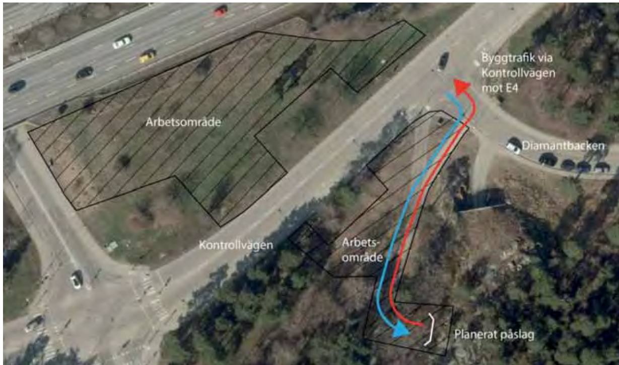
Figur 5 Föreslaget tunnelpåslag, planerat arbetsområde samt in- och utfart för byggtrafik.
