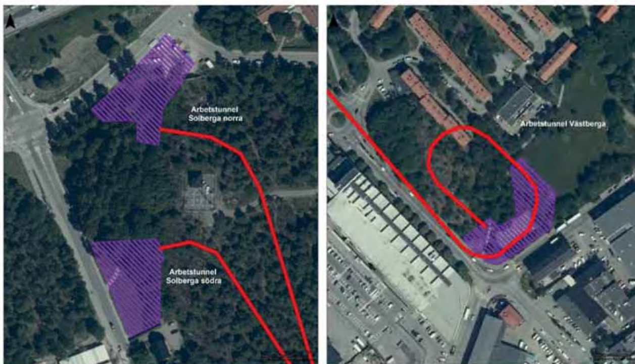
Figur 10 Vänster: Lägen för alternativt påslag till arbetstunnel i Solberga. Lila markering visar etableringsområden för respektive arbetstunnel. Etableringsområdet för Solberga norra är cirka 1500 m 2 och Solberga södra 2000 m 2 . Höger: Läge för arbetstunnel Västberga med 3000 m 2 etableringsområde.
