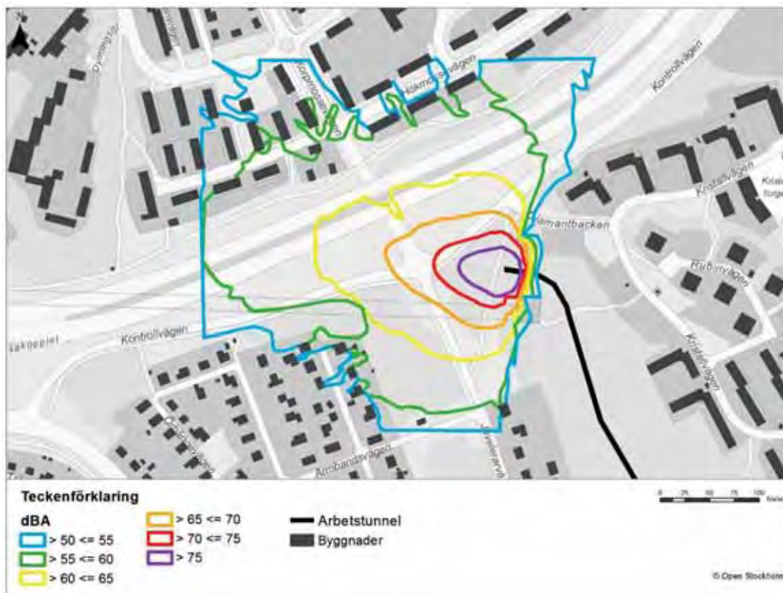
Figur 28 Ekvivalent ljudnivå för luftburet buller från fläktar, avser maxforcering av båda fläktarna.
