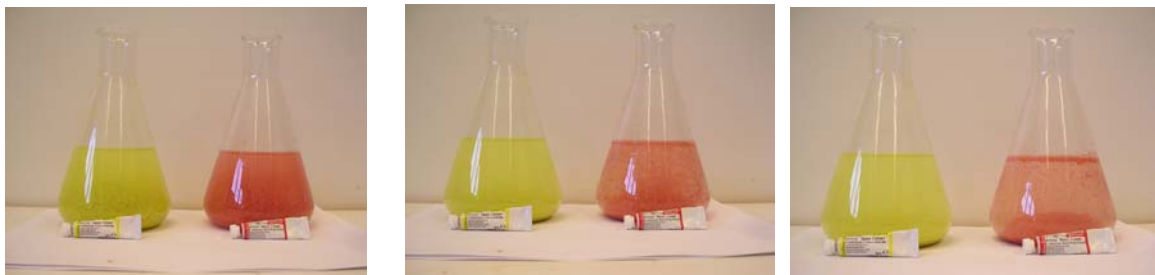
Bild 2, 3, 4. Flockulering efter tillsättning av bauxit, minut efter minut
