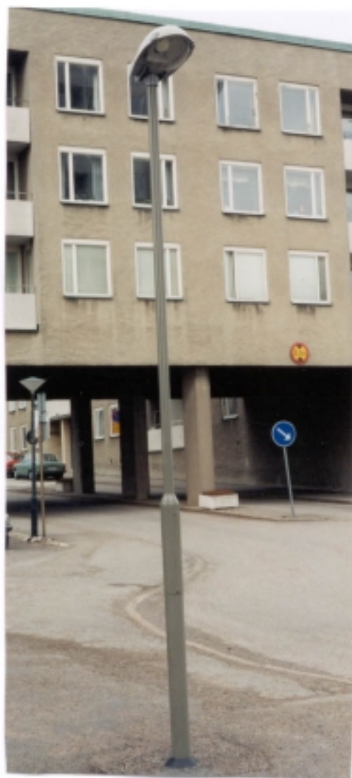
Figur 10: Målade förzinkade lyktstolpar. Höjd 3,7 - 4 m. Exponerad area ca 0,85 m 2 .
