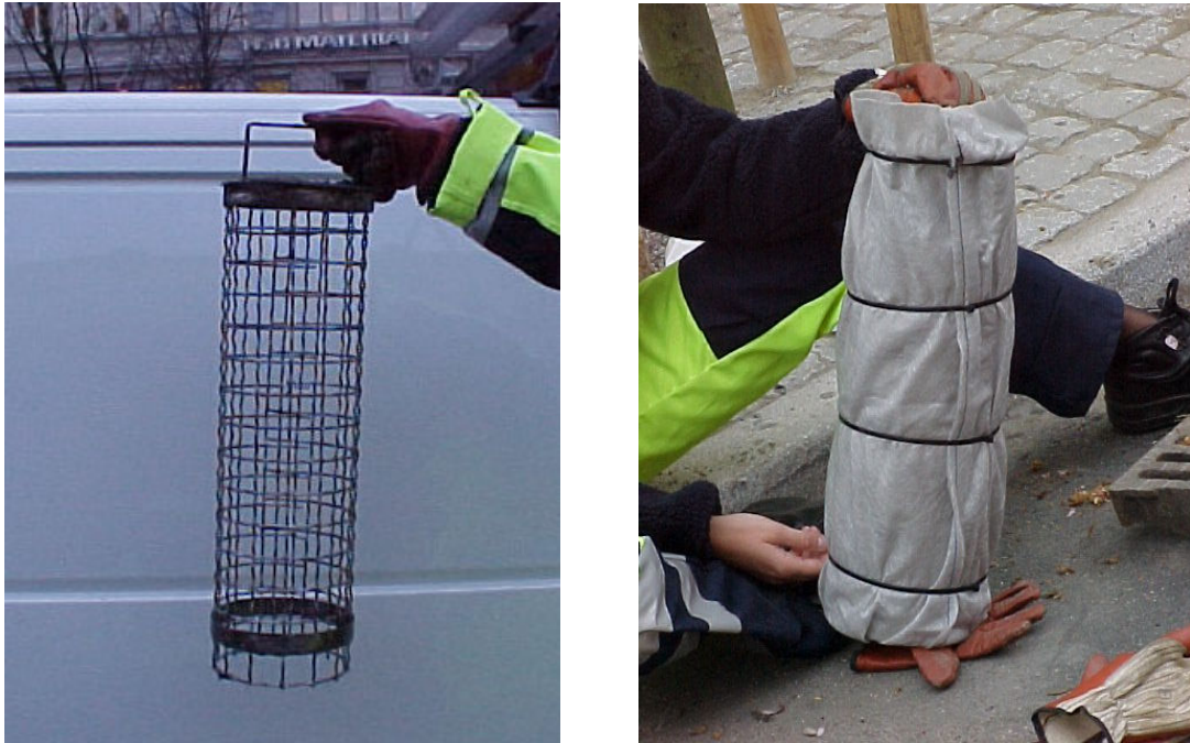
Figur 3.4 Foto på filterinsatsen i rännstensbrunnarna, med och utan filter.
