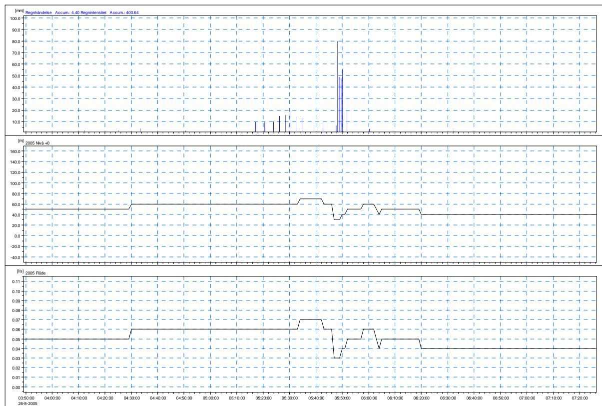
Figur 12 Ett utdrag ur regn- nivå och dränflödesmätningarna (observera att det är referensnivåer ej noll)
