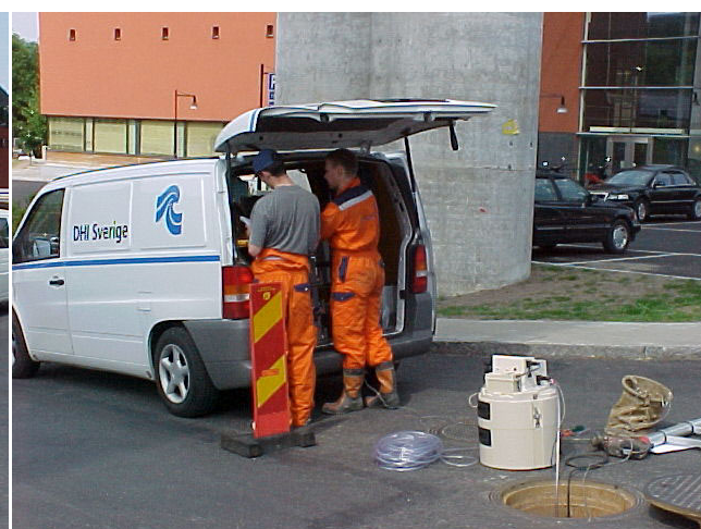
Mätbrunn inkommande ledning. SIGMA provtagare syns i förgrunden.
